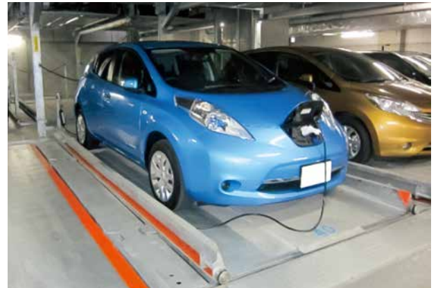
昇降横行装置の1Fパレット上で充電中
